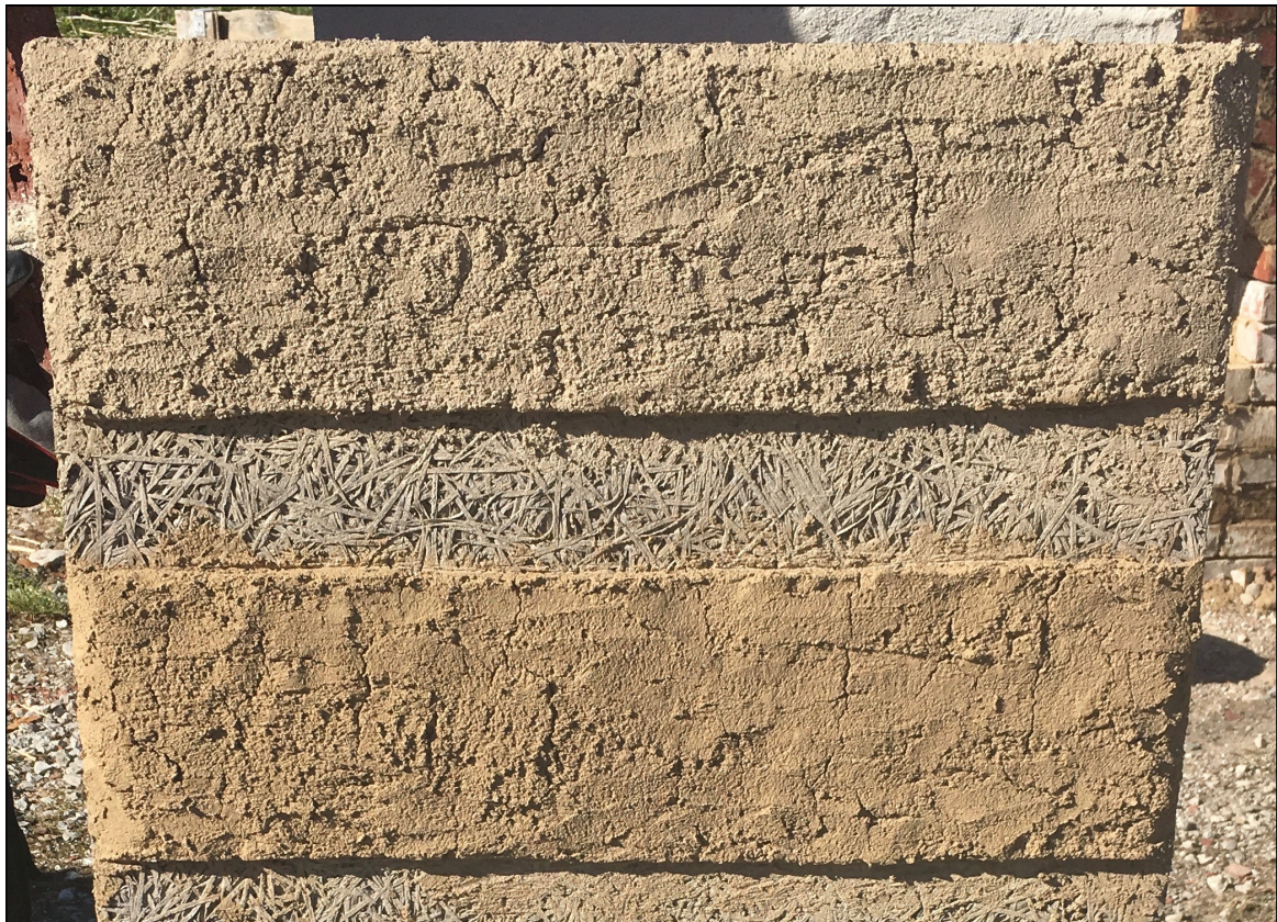
Bild 26. De två lerbruksutstockningarna efter torkning på Norrbys. Den övre putsen är pulverlera (blandning 1:2), och den undre är den lokala gulbruna leran (blandning 1:1). Notera att den undre lerutstockningen har något mindre krymsprickor än den övre.
