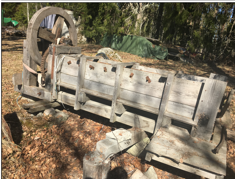
Bild 8. Lertegelmaskin från gården Blanks i Kalvhaga, Hälsingland. I karet hålls lerblandningen. En motorn det runda trähjulet, som i sin tur driver järnaxeln som blandar lermassan. I hålet längst till höger under karet ställs en tegelform. Den skjutsas in från ena sidan och kommer ut på den andra, fylld med välpackad lerblandning. Formen lossas därefter försiktigt och den välformade massan läggs i solen för att torka. Foto: Ellen Olsson, 2017-05-05.
