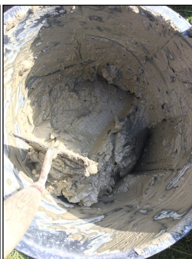
Bild 24. Den gråblå leran efter att den bearbetats med mursleven. Notera glansen som tyder på att leran är relativt fet.
