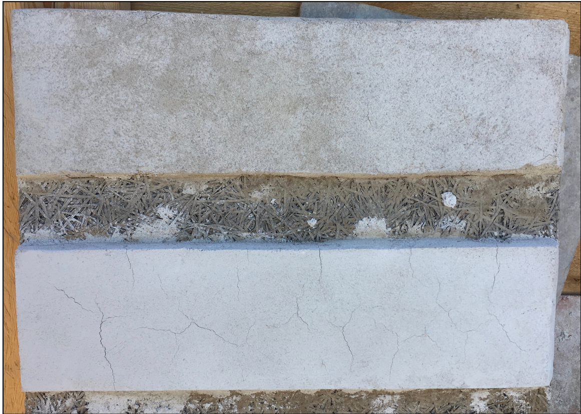
Bild 27. De två ytputserna av kalkbruk efter torkning. Den övre putsen är torrsläckt luftkalk (blandning 1:1,5), och den undre putsen är våtsläckt luftkalk (blandning 1:2,25). Notera de fina sprickorna på den undre ytputsen.
