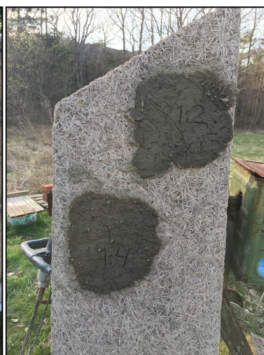
Bild 25. De två putsproverna som gjordes i Bohuslän efter åtta timmars torkning. Det övre provet är blandning 1:2 och det nedre 1:4.
